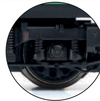
Ruedas de radios con rebajes
