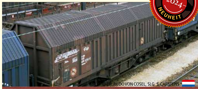
Teleskophaubenwagen Shimms 385 NS Betriebs-Nr. 31 88 437 3137-9
