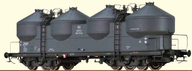
Staubbehälterwagen KKds55 DB Betriebs-Nr. 358 022
